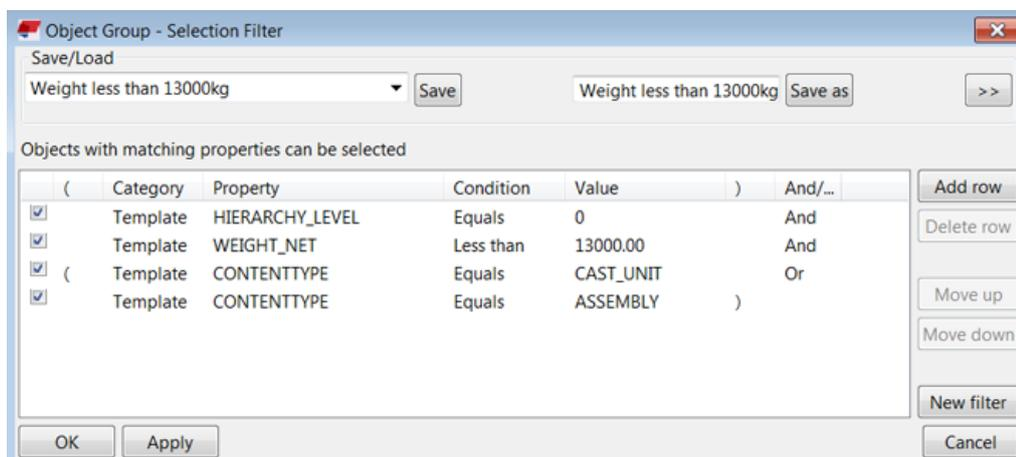
此过滤会选择所有重量小于 13 吨的钢构件和混凝土浇筑体。获取主构件重量需要使用分层结构属性。
