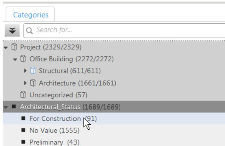
现在，您可以在 Tekla Structures 模型中自动跟踪建筑 IFC 对象的状态。
