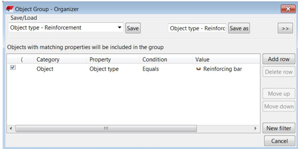
2. 为**对象浏览器**选择属性模板。在本示例中，选择**钢筋**模板。对于此类别，请不要选中**在模型中包含最高构件层次**复选框。如果选择仅包括构件，您将获得所有包含钢筋的构件。钢筋的最高构件级别是浇筑体。基于公称直径创建子类别。
