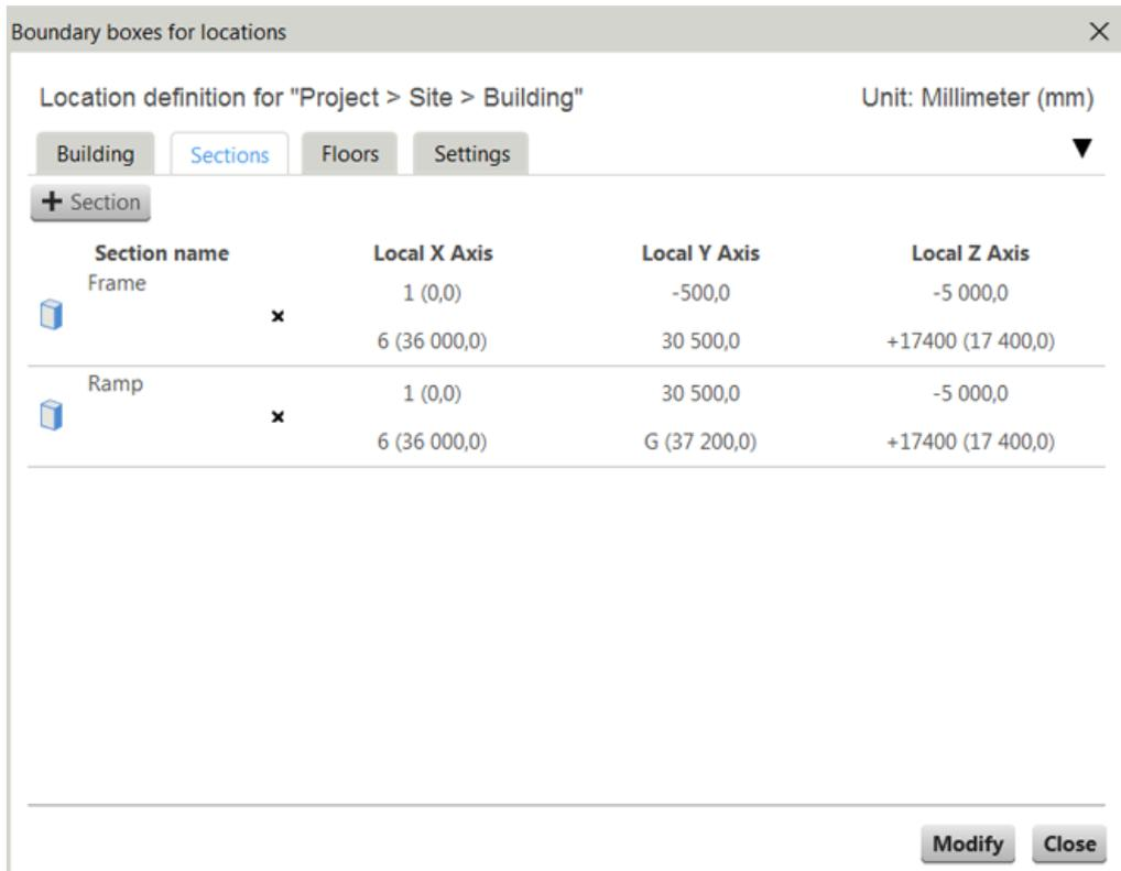
您可以单击截面名称前面的蓝色方框来显示模型中的剖面。下面的图片显示**边框**部分。
