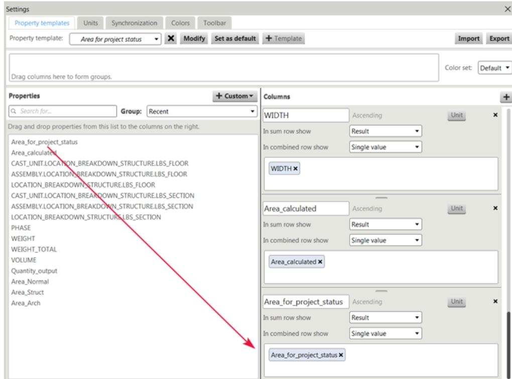
公式计算的属性值显示在**对象浏览器**中的 **Area\_for\_project\_status** 列。如果公式中的 **Quantity\_output** 是 1，在**对象浏览器**中将显示属性值。如果 **Quantity\_output** 是 0，**管理器**不增加值至对象属性。当 **Quantity\_output** 值是 0 时，**Area\_for\_project\_status** 公式等于  $\text{Area\_calculated}/0$ 。
