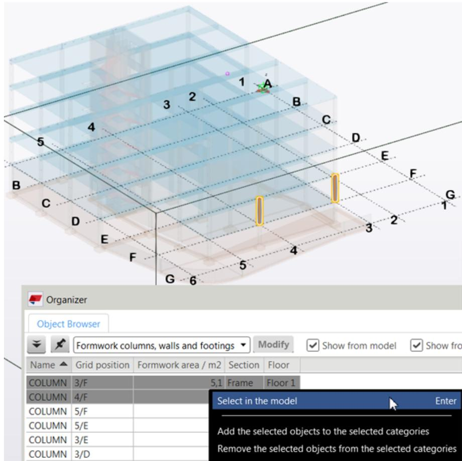
接下来，您要创建第一层柱的钢筋工料估算。
