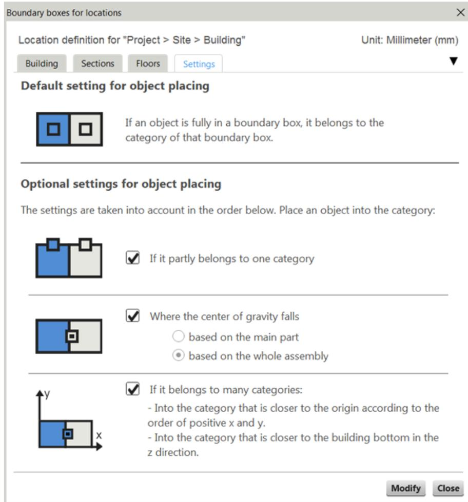
在默认情况下和根据选中的选项设置而无法包含在类别中的对象将被放置在自动创建的**无法识别**类别中，该类别在相关级别上创建。您可以修改边界坐标或手动将对象移动到正确的位置。
