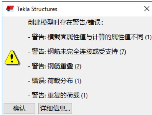
圆括号中的编号指示该分析模型中的相同问题类型的实例数量。
