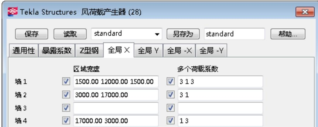
各墙按照建筑形状的点击次序编号。在本示例中，从建筑的左下角开始顺时针选取各点。
