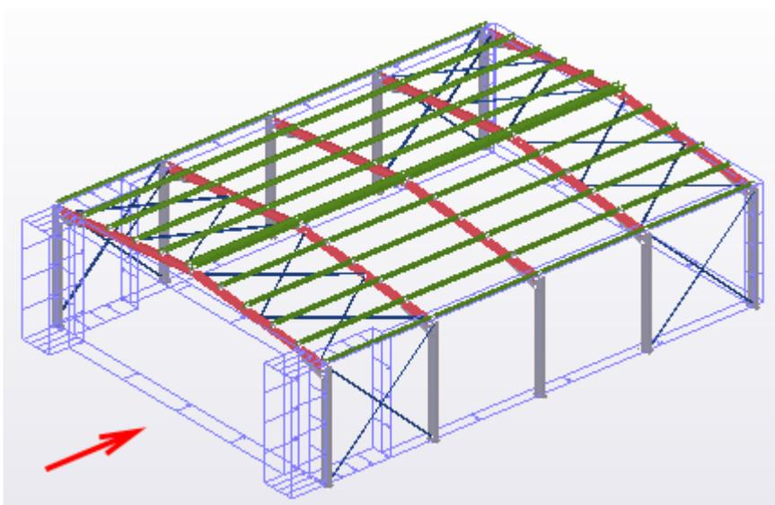
Les charges engendrées par le vent dans la direction x globale sont multipliées par 3 aux deux angles du mur 1 (mur exposé au vent), et aux autres angles des
