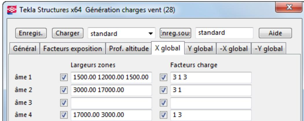
Les murs sont repérés selon l'ordre de sélection de la forme du bâtiment. Dans cet exemple, les points étaient sélectionnés dans le sens des aiguilles d'une montre à partir de l'angle inférieur gauche du bâtiment.
