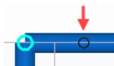
5. Se necessario per l'estremità di una parte supportata, definire la rotazione.
