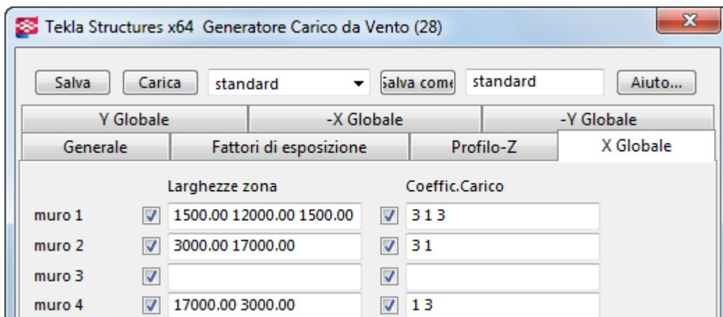
Le pareti sono marcate in base all'ordine di selezione della forma dell'edificio. In questo esempio, i punti sono stati selezionati in senso orario dall'angolo inferiore sinistro dell'edificio.
