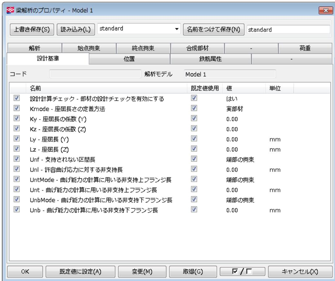
適切な解析部材プロパティダイアログボックスを使用して、特定の解析部材の設計プロパティを変更できます。[値]列で値の変更やオプションの選択を行うと、[既定値使用]列のチェックボックスがオフになり、この特定の解析部材および設計のプロパティで、解析モデルプロパティが使用されないことが示されます。
